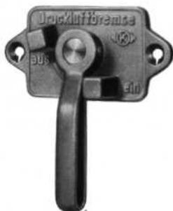
Bild 12 Bremsumstellvorrichtung ein – aus
