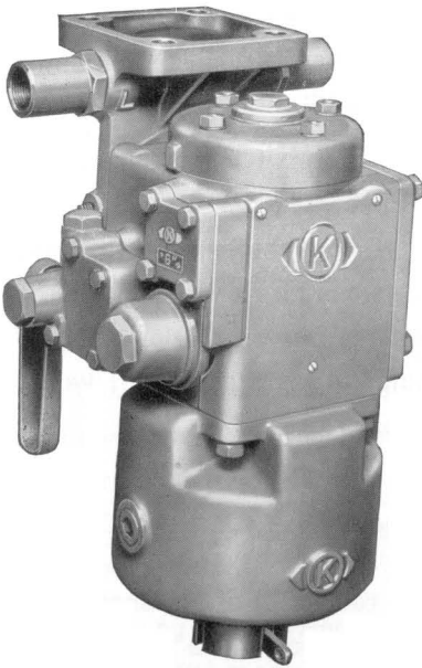
Fig. 10. Styrekammer A monteret på enheds-grundventilen
