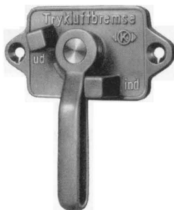
Fig. 13. Omstilling ind — ud for trykluftbremsen
