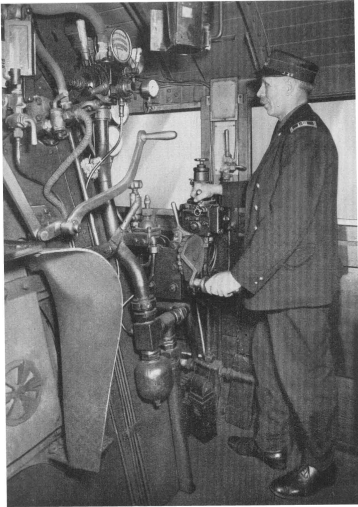
Fig. 48 Automatisk Førerventil, Konstruktion Knorr, i Førerhuset paa et dansk Lokomotiv
