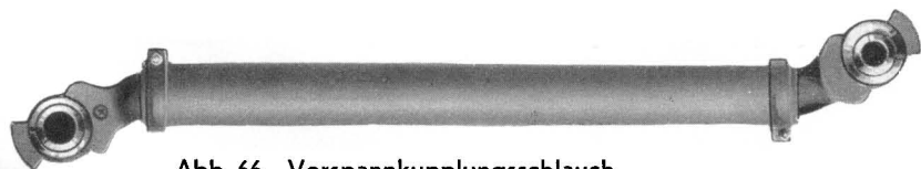
Abb. 66 Vorspannkupplungsschlauch
